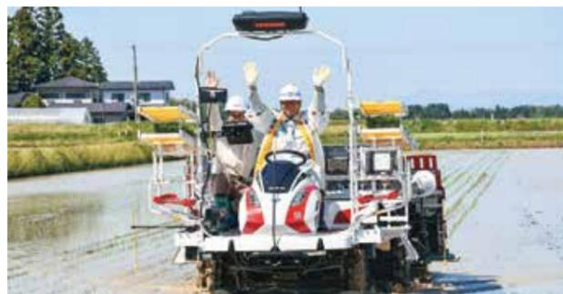
オペレーターが搭乗した状態で、基準線に沿って自動で直進進行します。回転時の一連の作業も自動化し、田植え作業と苗補給を1人で実現可能となります。人間とは違い疲れを知らないため、最高速度で植付作業を行っても高い作業精度を維持しながら能率向上が期待できます。
